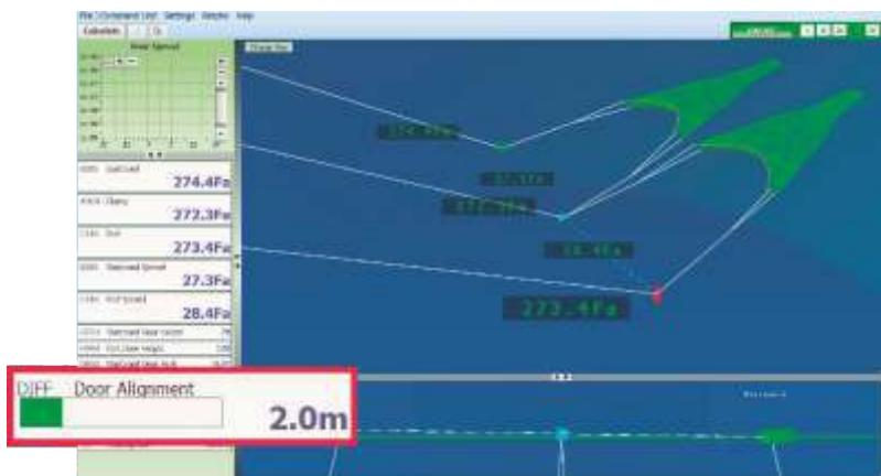
Датчик сцепки позволяет скорректировать длину среднего ваера для выравнивания сцепки относительно траловых досок, что гарантирует высокую эффективность работы траха.
