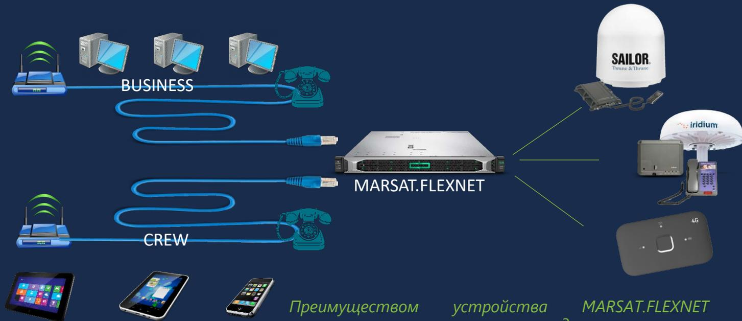
Преимуществом устройства MARSAT.FLEXNET является возможность переключения между различными спутниковыми каналами, маршрутизируемыми в единую наземную сеть. С стороны пользователя технические параметры сети, качества связи, адресация остается неизменной.
